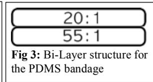
**Fig 3:** Bi-Layer structure for the PDMS bandage
